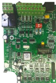
Рисунок 9.5 – Плата управления с покрытием лаком
