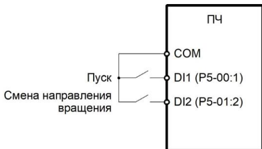
Рисунок 6.10 – Схема двухпроводного подключения 2
