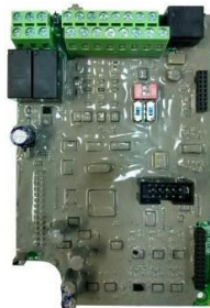
Рисунок 9.4 – Плата управления с покрытием компаундом
